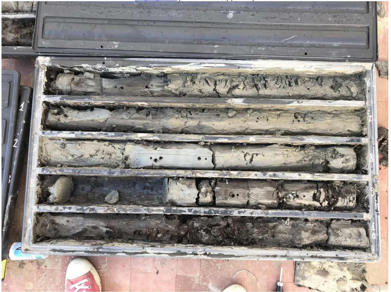
Fig. 4/4: cassetta catalogatrice delle profondità comprese fra 5 e 10 m dal p.c.
