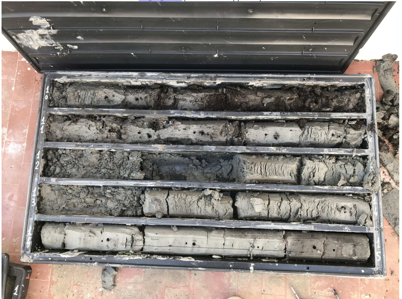
Fig. 4/5: cassetta catalogatrice delle profondità comprese fra 10 e 15 m dal p.c.
